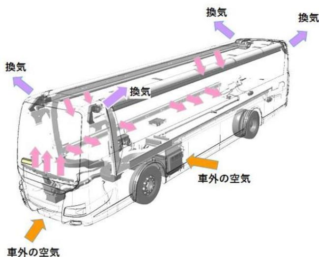
弊社バスには、内気や外気の汚れを感知し、自動で内気循環・外気導入に切り替える換気制御装置を備え付けております。
