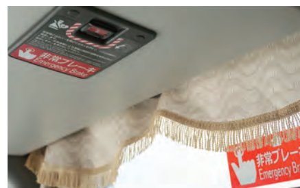
【非常ブレーキボタン】 緊急時に乗客が作動させられます
